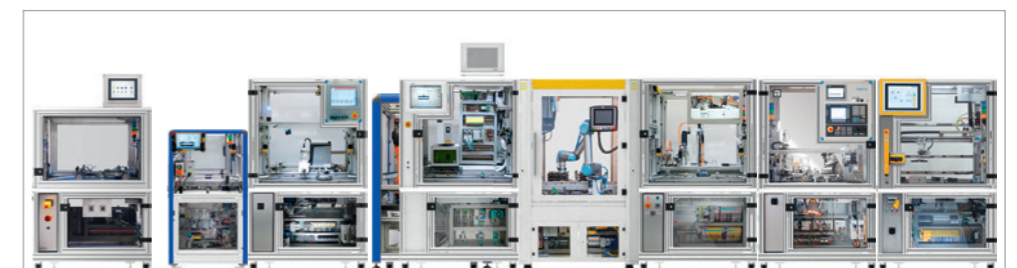
Abbildung 5: Der Produktionsprozess für die Herstellung des Visitenkartenetuis besteht derzeit aus bis zu acht verschiedenen Produktionsmodulen.
